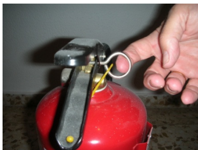
- Sacar la anilla de seguridad para poder accionar el mecanismo de disparo. Dispone de un precinto de seguridad que se elimina de un simple tirón
