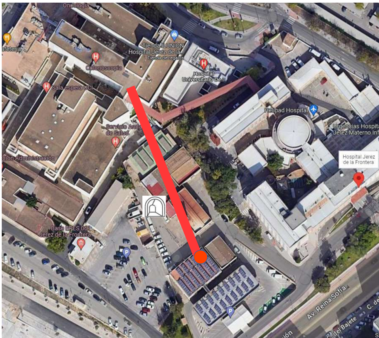
Recorrido de galería subterránea que une el sótano de la Central Térmica con la planta -2 del Hospital General.
